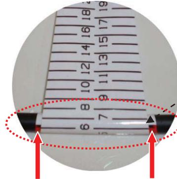
Range of the cable entry: Ø mini 3mm. Ø maxi 7mm
